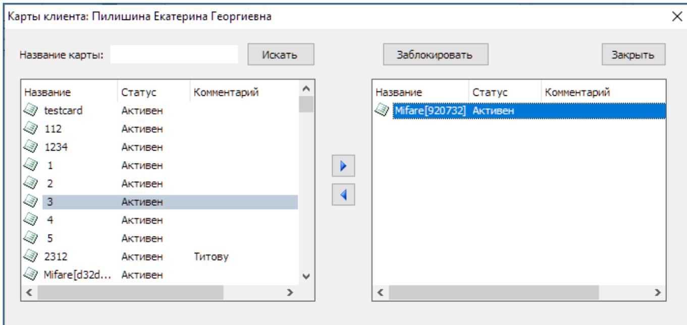
Поднесите пластиковый пропуск к считывателю. Если пропуск заведен в системе и не закреплен ни за одним из посетителей, то эта карта автоматически присвоится текущему посетителю. Если карта уже закреплена за другим посетителем, то система выдаст соответствующее предупреждение. Система выдаст предупреждение и в том случае, если данная карта не заведена в системе (заведение карт в системе осуществляется в [APM менеджера](#)).
